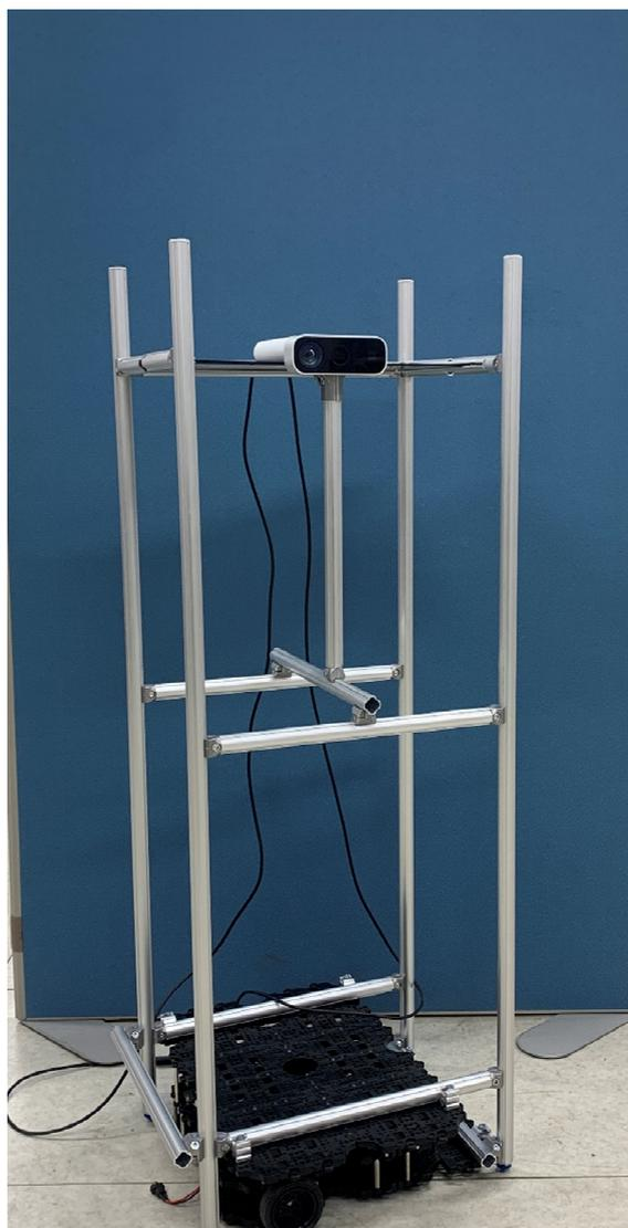
図 2-13 移動ロボットのフレーム
