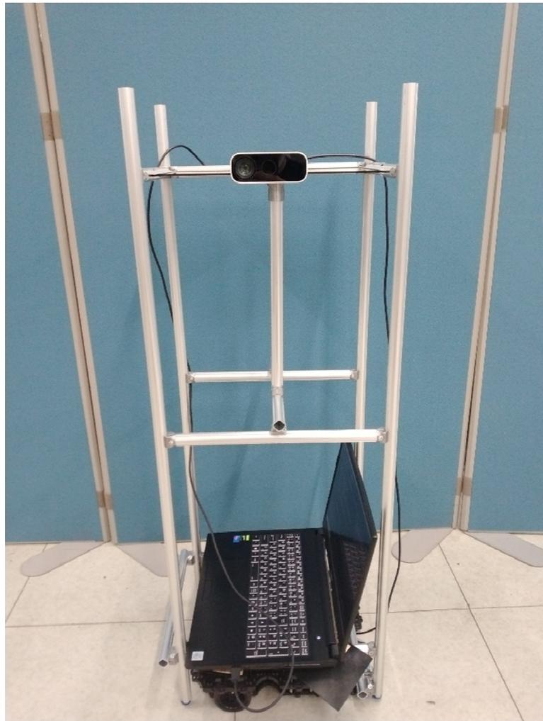
図 1-5 ジェスチャーで操作する移動ロボット
