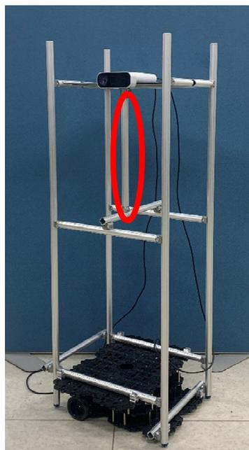
図 2-18 Azure Kinect を取り付けしたロボット
