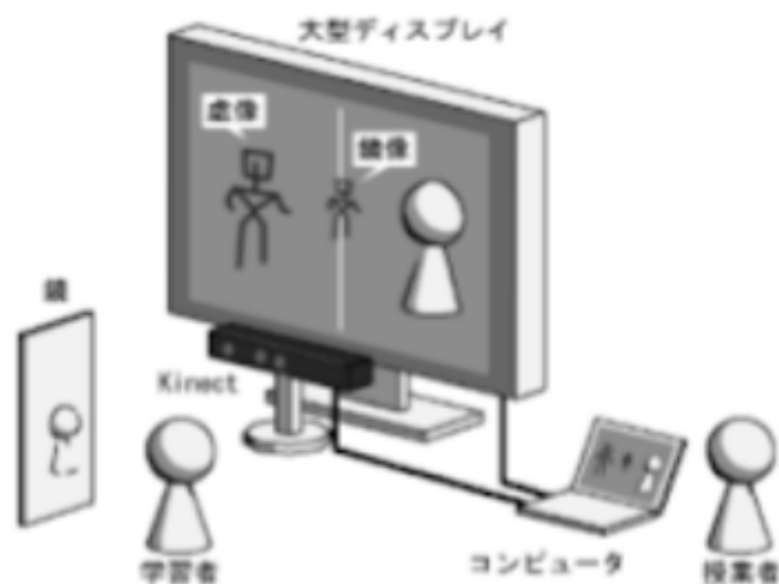
図 1-10 Kinect を用いた AR による鏡像シミュレーション教材の概略図【出典：[10]】
