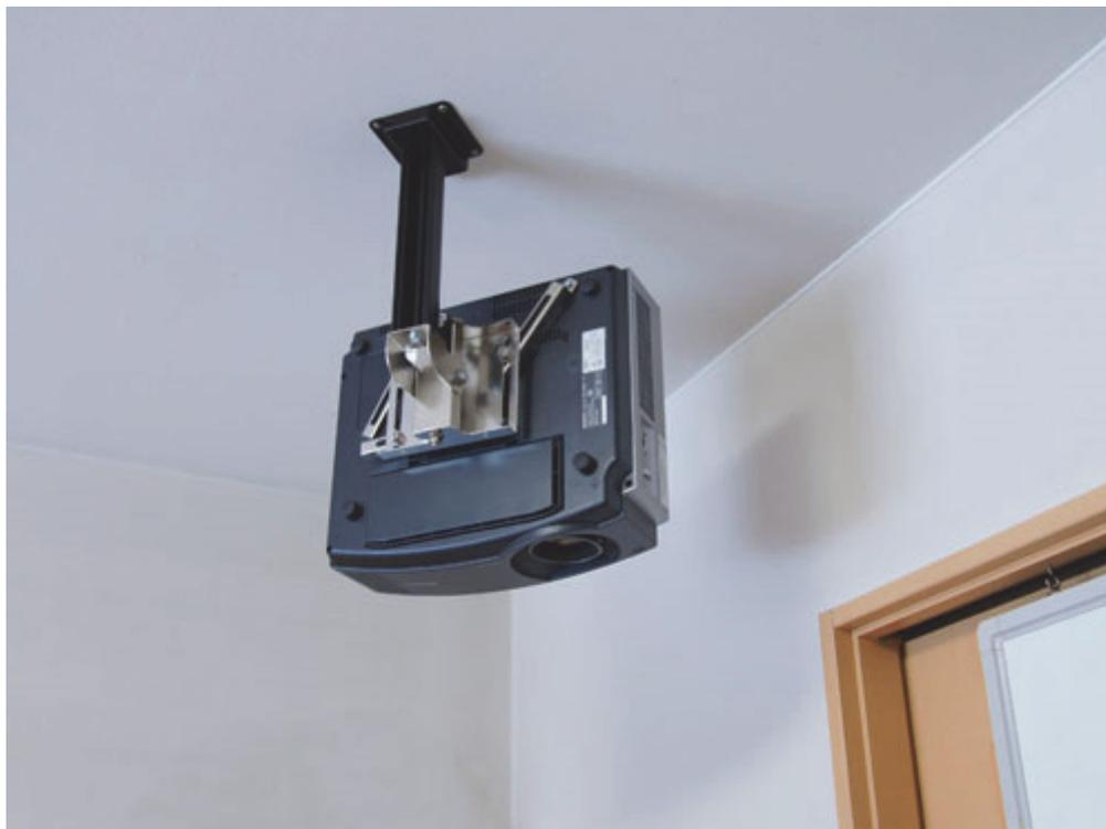
図 4-2 床に画像を投影する為にプロジェクタを吊る器具の一例[11]
