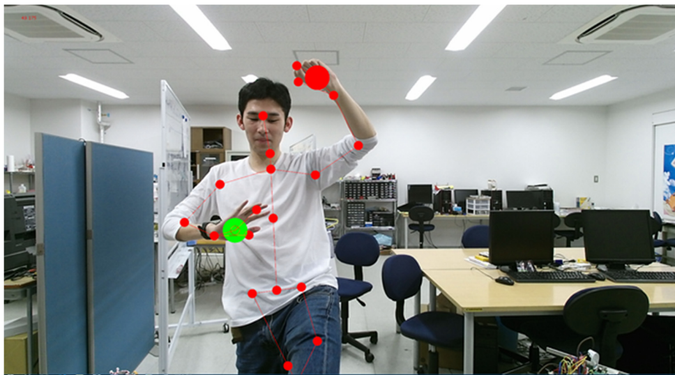
図 1-9 Kinect v2 による人の関節位置取得
