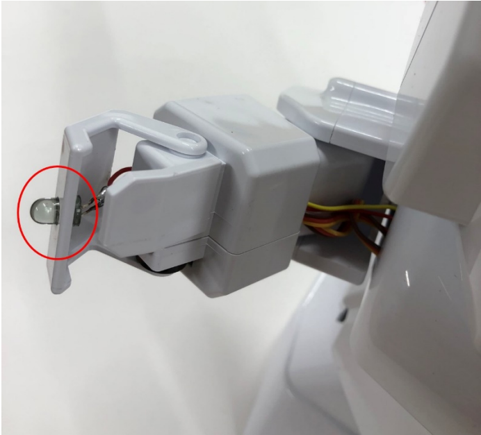
図 6-4 Rapiro 右腕甲 赤外線 LED 装着後
