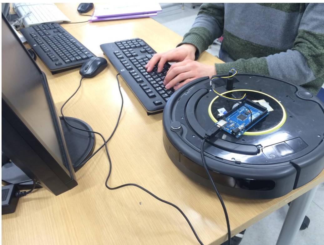
図 4-8 PC と Arduino を用いたルンバの操作テスト
