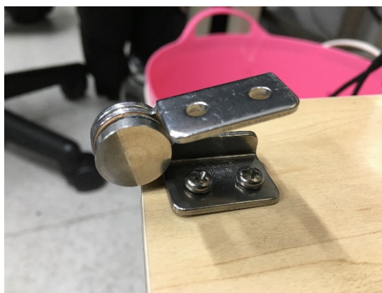
図2-27 棚に取り付けられたトルクヒンジ
