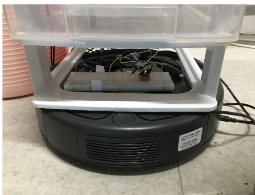
図 2-24 棚を設置した自走ロボット
