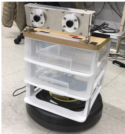
図 5-1 完成した自動書類運搬装置
