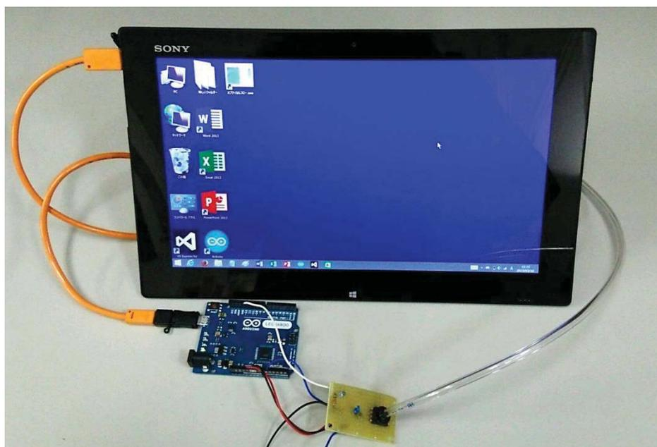
図 4.31: Arduino を含む回路と Windows タブレットの配線
