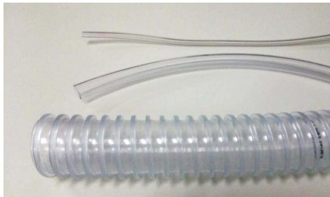
図 4.7: 使用したチューブ (上から内径 2mm、10mm、30mm)
