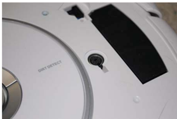
図 3-8 実際のルンバのコネクタ
