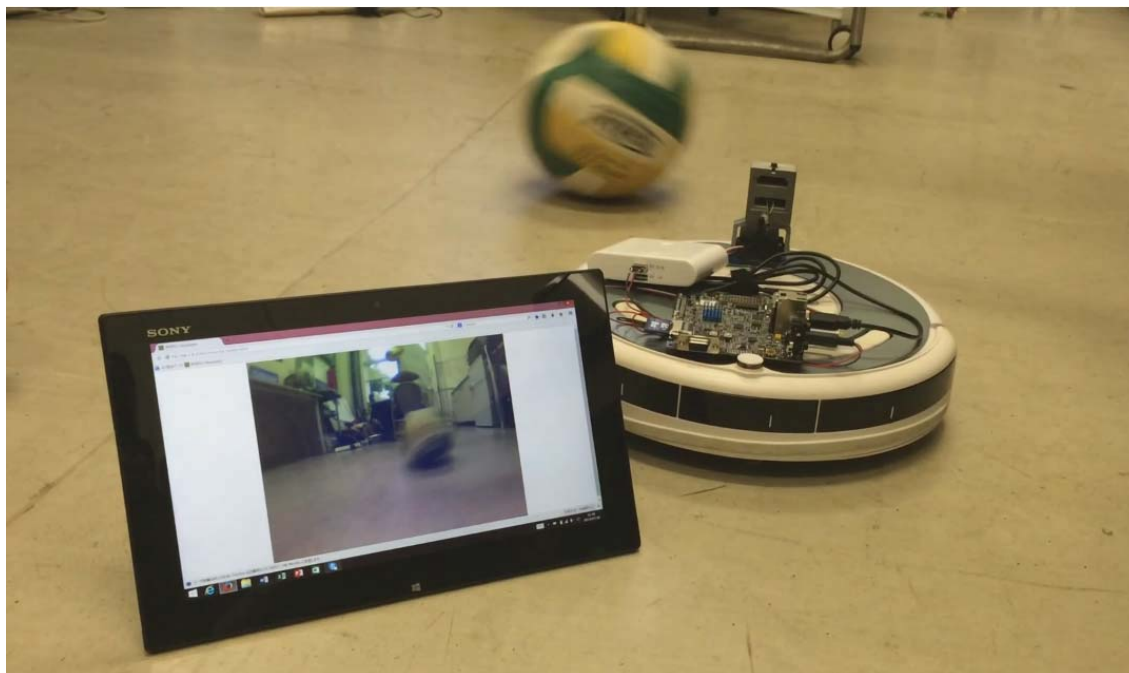
図 4-6 PandaBoard を用いた映像検証
