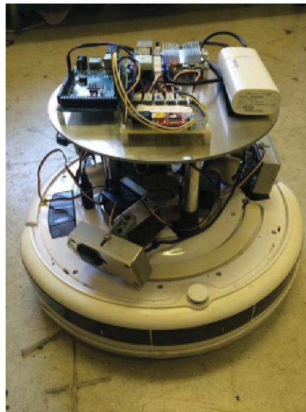
図 5-1 車載用広角レンズを用いた室内見守りシステムの完成図
