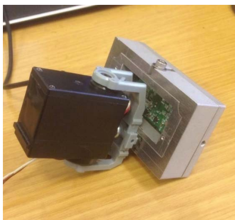
図 2-28 第 3 カメラの左右方向の組み立てた様子
