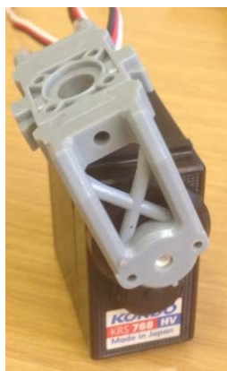
図 2-27 サーボモータとサーボアームを組み立てた様子
