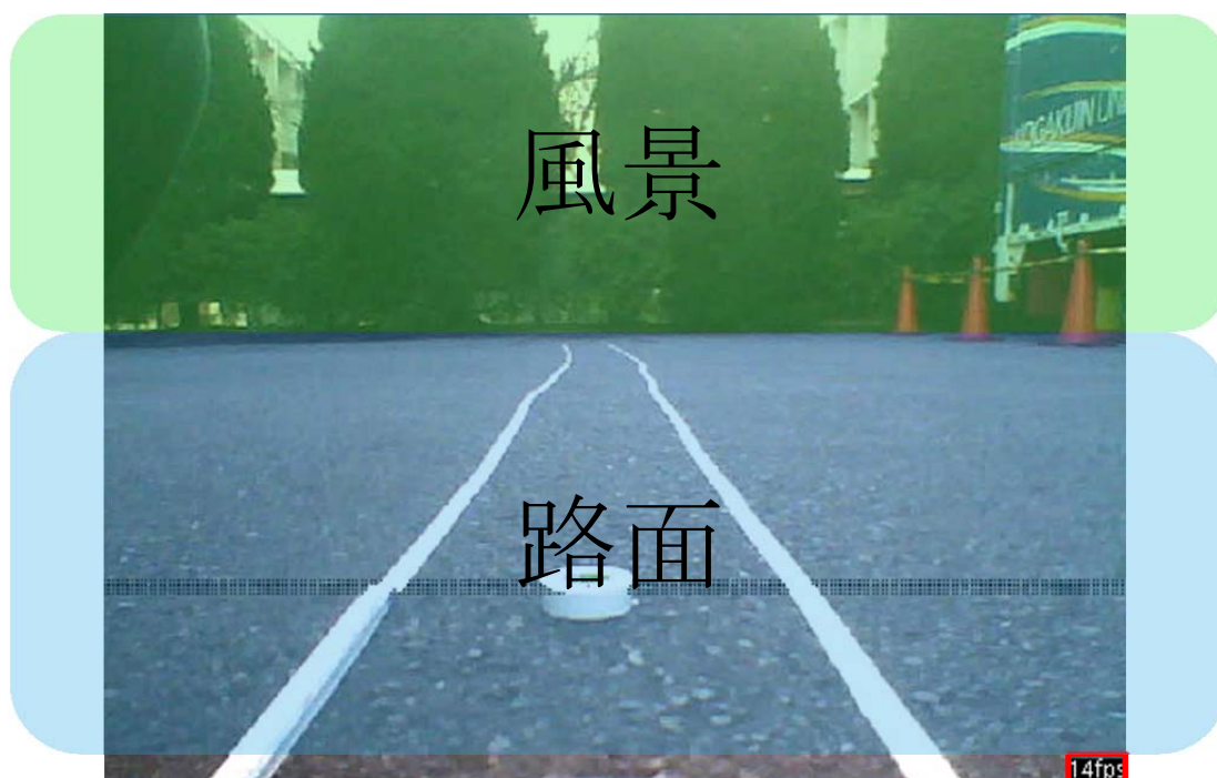
図 6.3 車体ルーフに設置した WiFi カメラからの視野
