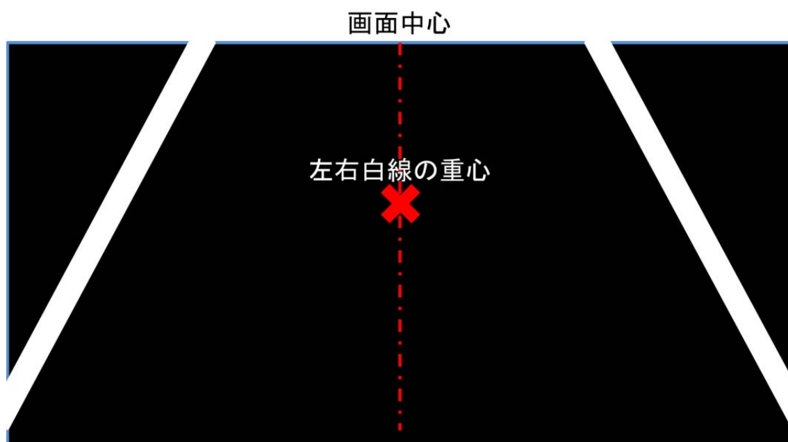
図 6.4 画像処理による重心計算イメージ
