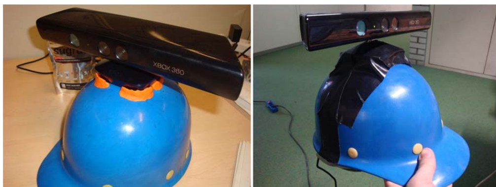
図 1.5 Kinect の装着方法 [11]
