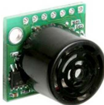
図 2.4 超音波センサの概観 [17]
