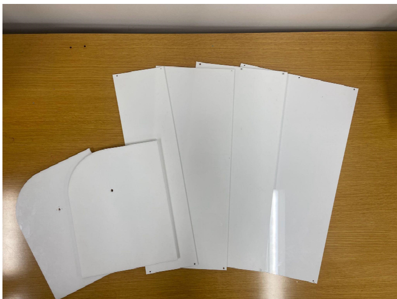
図 33 カット及び穴あけ済みのアクリル板
