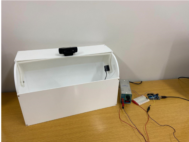
図 55 全ての機器を接続し、完成したダストボックス
