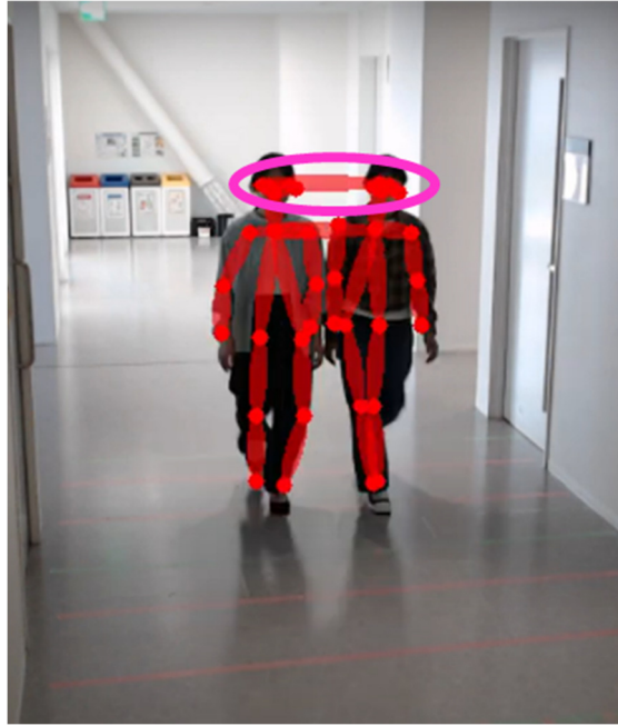
図 27 OpenPose の認識失敗例 (0.2m)
