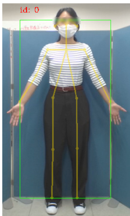
図 8 Lightweight OpenPose[15][16]による骨格推定
