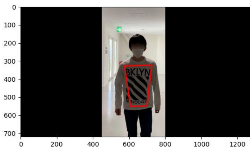
図16 1フレーム目から得られるテンプレート領域(赤い四角形)
