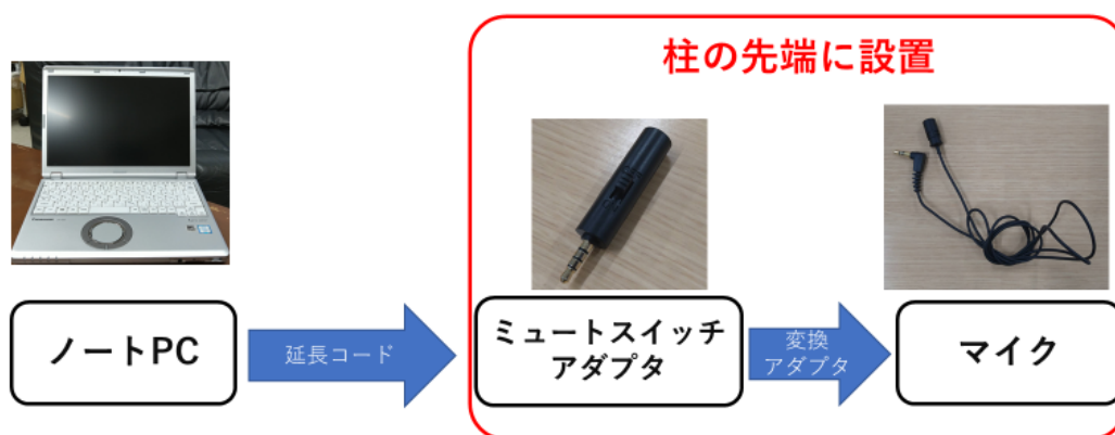
図 6.9 ノート PC からマイクまでの接続方法
